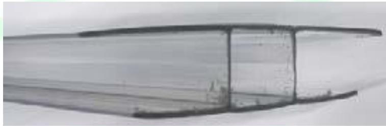
Colocar los perfiles a la separación adecuada (tamaño de los paneles + 5mm a cada lado del panel o adecuarse al lugar de instalación) e ir insertando los paneles entre los perfiles. En el caso de cubiertas curvadas, (tener en cuenta el radio mínimo de curvatura del panel), fijar el perfil a las correas con tornillos y la curvatura se mantendrá fija.
