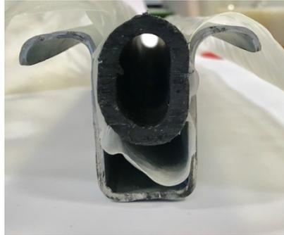
Detalle fijación plástico perfil omega.
